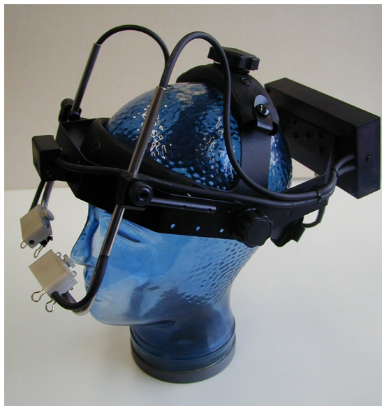
Abbildung 4.14: Ein Beispiel für eine Eye-Tracking Kamera [tea10]
